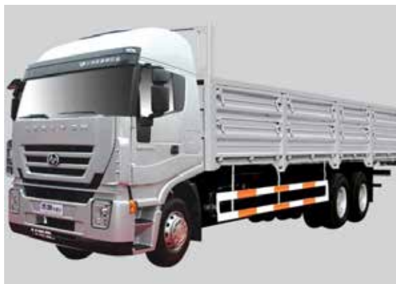
Figura 7: Camión de tres ejes 27 Ton
