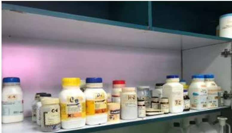
Figura 10. Almacenamiento en orden alfabético. Fuente: Gonzalez M, (2023)
