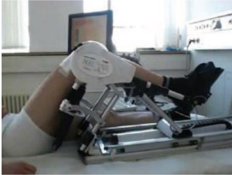
Figura 18 Dispositivo mediante actuadores neumáticos.
