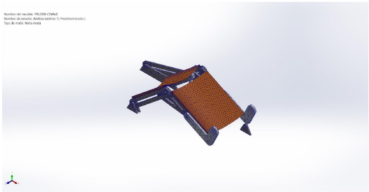
Figura 61. Control de mallado.
