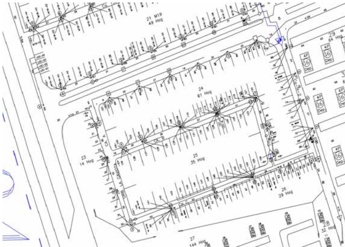
Figura 7. Distribución de red de Servicio de Tv por cable en el Subnodo SDG04D.
