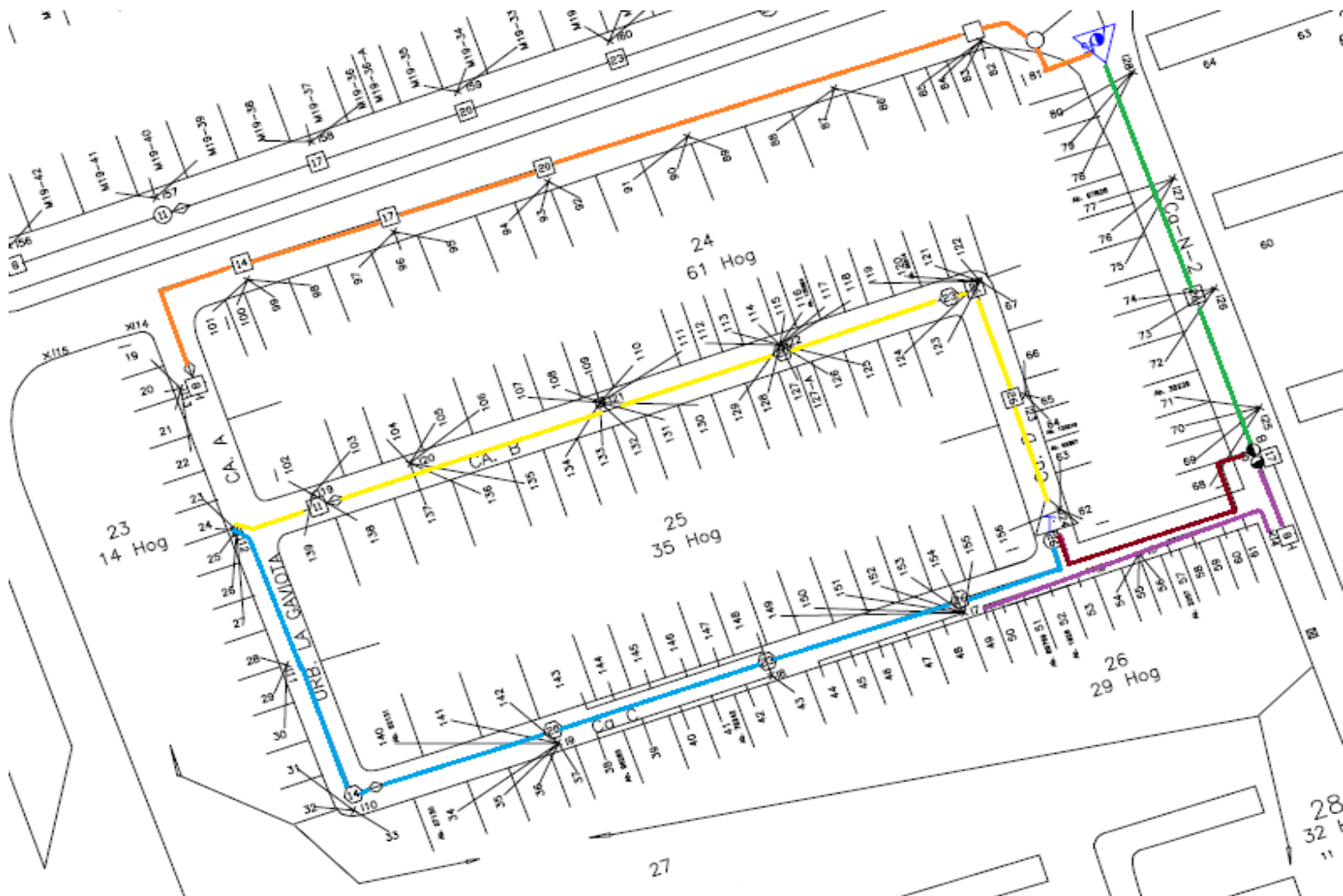
Figura 23. Plano de tramos y elementos activos existente en la Urbanización la Gaviota Fuente: Bueno, Polanco (2020)
