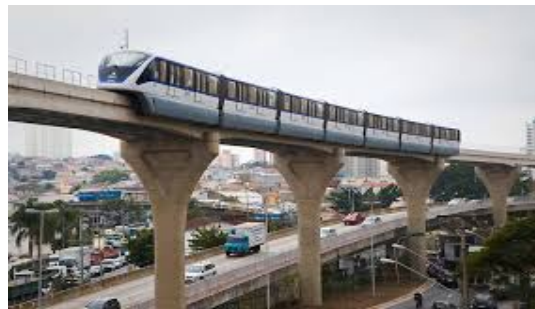
Figura 42. Modelo Monorriel tipo elevado avanzando sobre carril de concreto armado.
