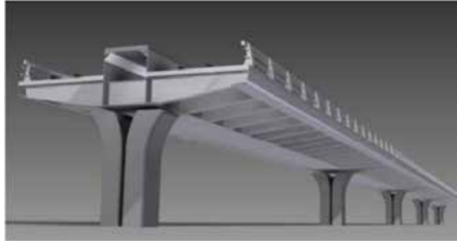
Figura 15. Columnas en concreto armado
